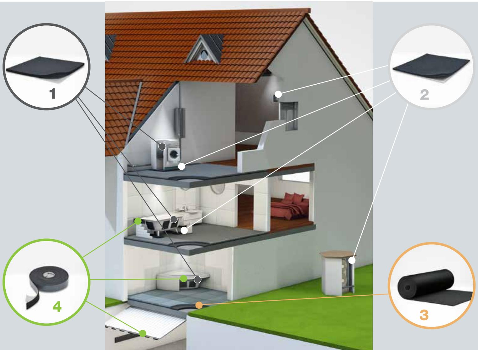
Mit vier verschiedenen Produkten bietet Armacell ein umfassendes Lösungspaket für besseren Schallschutz und höheren Wohnkomfort in Wohngebäuden. So verringert die Produktreihe ArmaComfort® beispielsweise Körperschall ab 1000 Hz um bis zu 36 dB. Die selbstklebenden Mehrschichtprodukte sind speziell auf die verschiedensten Anwendungsgebiete im Wohnbereich zugeschnitten. Die Montage ist einfach auszuführen, es werden keine Spezialwerkzeuge benötigt.
